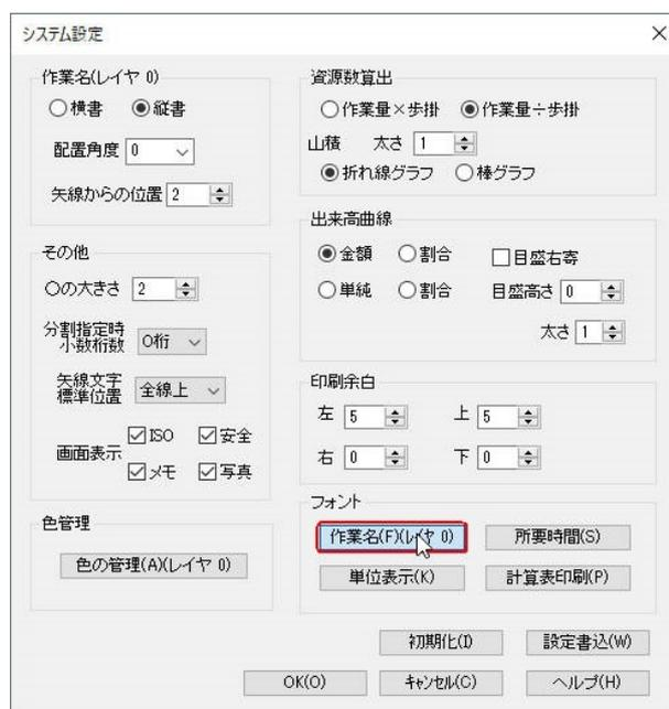
[フォント] の [作業名] をクリックし [作業名フォント] の画面でサイズを変更します。なお、プルダウンリストにないサイズは直接数字を入力します。
